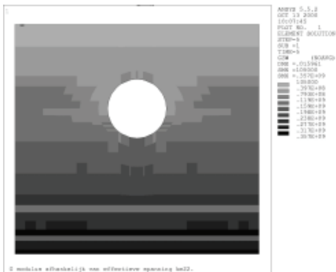
Figuur 6: Verdeling G modulus afhankelijk van de effectieve spanning
