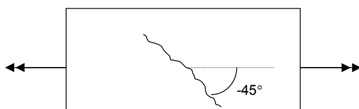
Figuur 35: Scheur door torsiemechanisme (of afschuiving)
