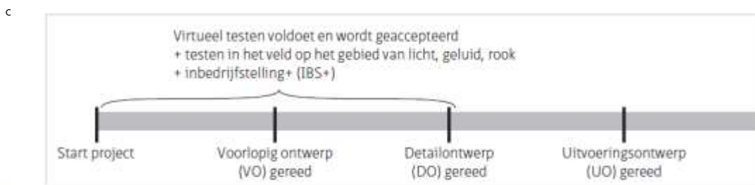
Figuur 5.1 / Virtueel testen in relatie tot ontwerpfasen.
