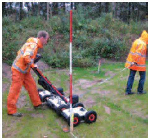
Medewerkers van detectiebedrijven in de weer met grondradar en radiodetectie. (Foto: COB)
