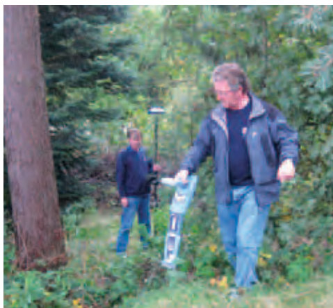
Medewerkers van detectiebedrijven in de weer met grondradar en radiodetectie. (Foto: COB)
