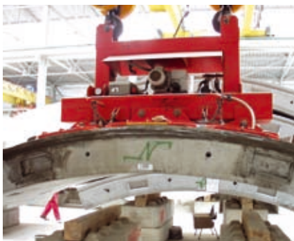
Afbeelding 6.7 Element voor ringbouwmethode (Tubbingen)
