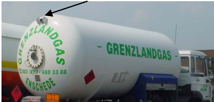
Afbeelding 11: Overdrukventiel aangebracht aan achterzijde tankauto (bovenaan).
