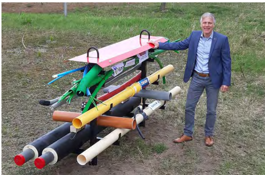
Pieter van Leeuwen toont een prototype van een Verticaal Kabels & Leidingen Systeem.
