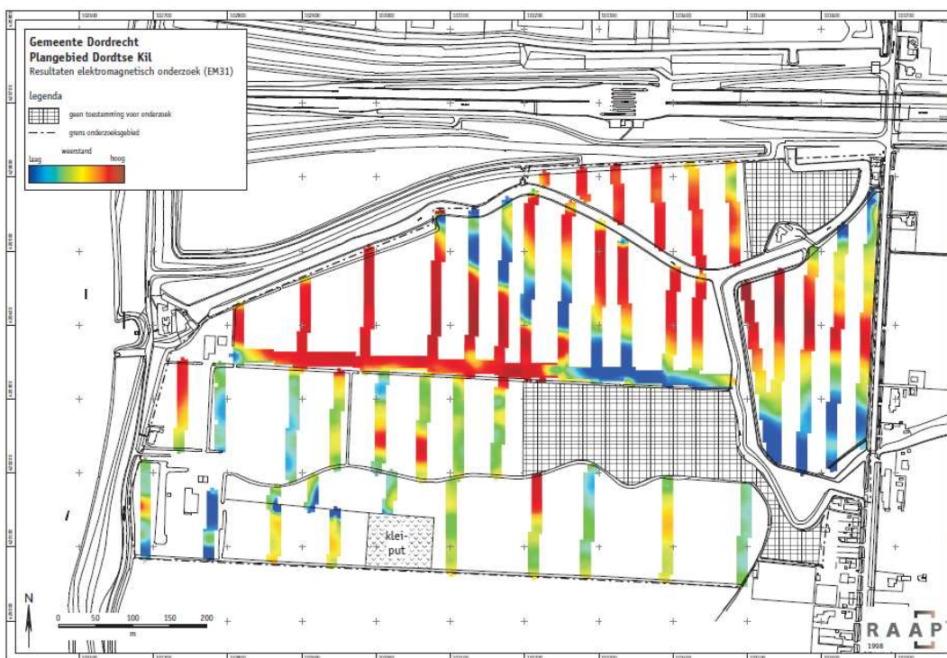
Figuur 6: Resultaten van een elektromagnetisch onderzoek uitgevoerd met een EM31 in de gemeente Dordrecht (RAAP 1998, RAAP-rapport 349).
