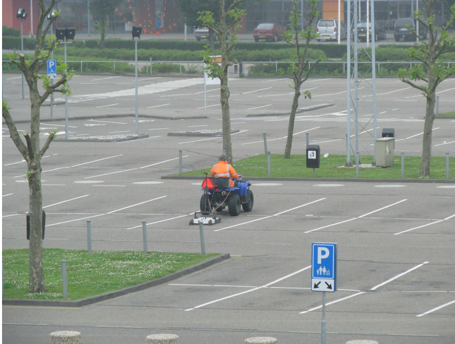
Figuur 8: Grondradar onderzoek wordt uitgevoerd met een groundtracer in de gemeente Son en Breugel (ArcheoPro 2010, ArcheoPro-rapport 832).
