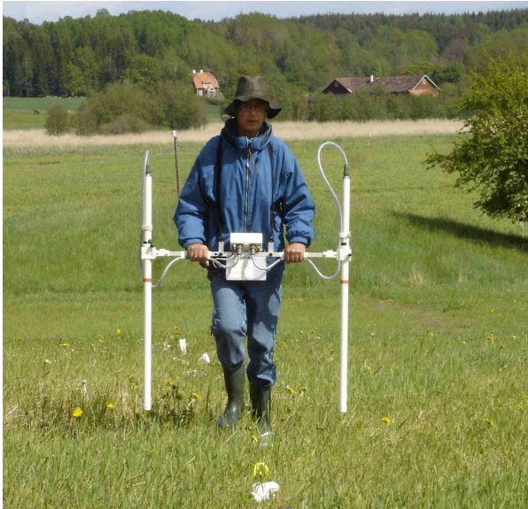
Figuur 3: Onderzoek wordt uitgevoerd met een Grad601-2 fluxgate gradiometer (magnetometer) ( http://www.archaeologicalgeophysics.co.uk/magnetometry.htm ).
